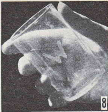
Incisione del vetro per mezzo della sola sostanza in grado di aggredirlo, ossia l'acido fluoridrico. A sinistra è visibile l'operazione in corso e soprattutto la riserva destinata a proteggere le zone di vetro da non incidere. Nella foto a destra, invece, a trattamento avvenuto, è visibile la incisione, sul vetro liberato dalla riserva e lavato a fondo.
