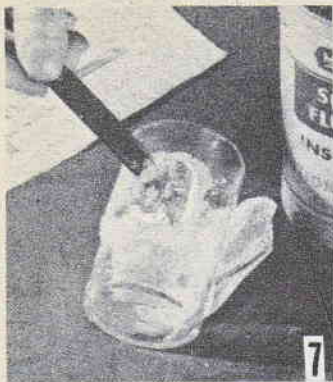
Incisione del vetro per mezzo della sola sostanza in grado di aggredirlo, ossia l'acido fluoridrico. A sinistra è visibile l'operazione in corso e soprattutto la riserva destinata a proteggere le zone di vetro da non incidere. Nella foto a destra, invece, a trattamento avvenuto, è visibile la incisione, sul vetro liberato dalla riserva e lavato a fondo.
