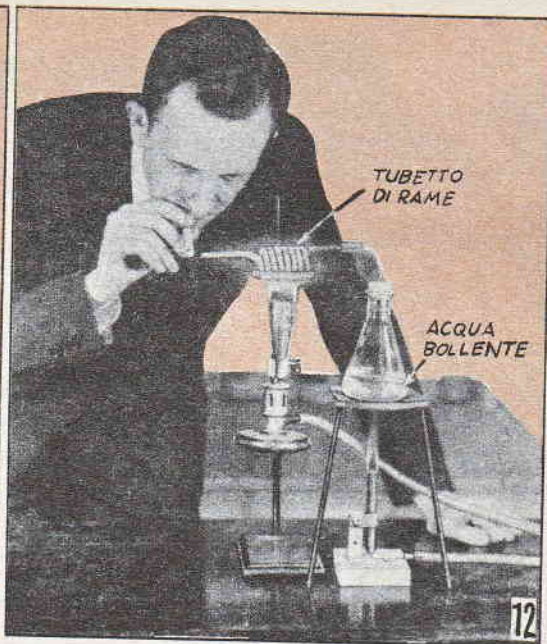
(Foto 11): Preparazione di una essenza profumata artificiale, per mezzo di una reazione tra composti organici, catalizzata da poche gocce di acido solforico. — (Foto 12): Esperienza interessante, intesa a dimostrare che la temperatura del vapore acqueo, può essere elevata quasi indefinitamente, al punto di mettere il vapore stesso di causare delle reazioni simili a quelle prodotte da una fiamma, quale l'accensione di una sigaretta, ecc.
